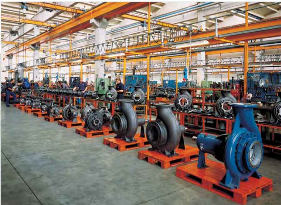
Assemblaggio pompe centrifughe - Centrifugal pumps assembly
